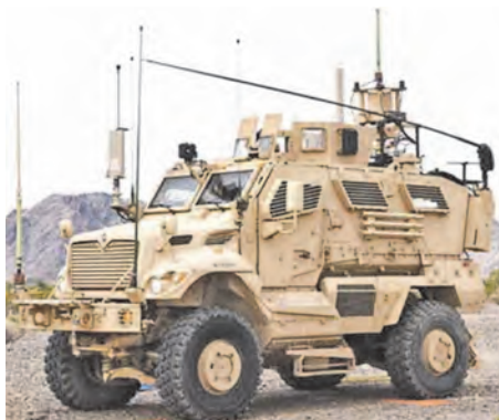
Рис. 11. Мобильный комплект радиоэлектронной борьбы EWTV на базе бронетранспортера
